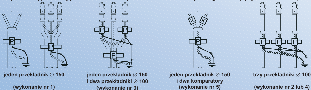
Rys. 5 Montaż przekładników prądowych i komparatorów na kablach SN w zależności od wykonania
